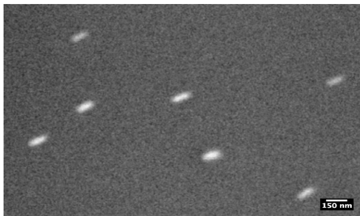
Figura 3. Micrografía electrónica de barrido para la deposición a 3 L/min. Magnificación: 50,000x.
