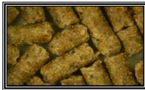
Fotos 5 y 6. Alimentos presentación migaja después de una hora de inmersión en agua con partículas de ingredientes mal molidos (Muestras 8 y 11).
