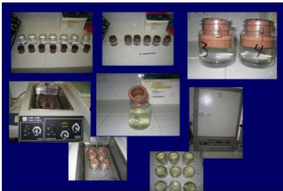
Foto 15. Materiales y equipos usados en el Programa Maricultura para determinar estabilidad de los alimentos para camarón en agua
